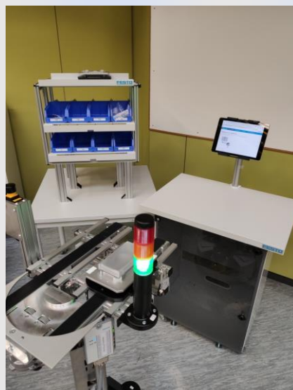
Der Handarbeitsplatz als Versand. Der Robotino bringt das fertige Produkt.
