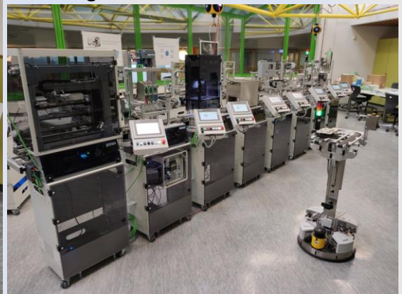
Der Robotino bringt den leeren Warenträger vom Versand zum Hochregal.
