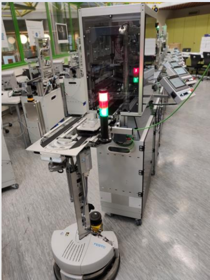
Der Robotino dockt an das Hochregallager an
