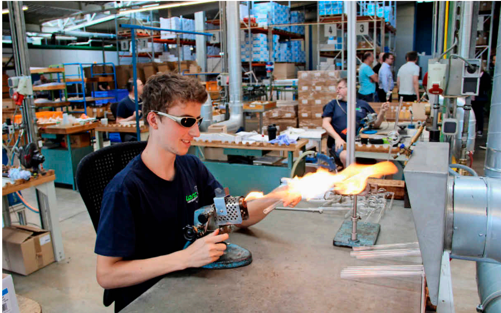
Im ersten Lehrjahr zum Glasapparatebauer bei der Wertheimer Firma Laborglas Lenz ist Robin Kettner (16) aus Reicholzheim, der hier gerade einen sogenannten Reitmeyeraufsatz fertigt.
